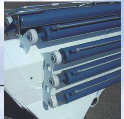
Sistema blocco cilindri gru chiusa Cylinders locking system when crane is folded Système de retenue vérin a grue fermé Halterung System mit zusammengelegten Kran
