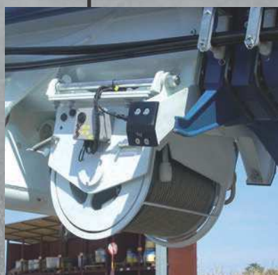
Verricello tiro diretto 4000 daN - (OPZIONE) (2500 daN con JIB) 4000 daN (2500 daN with JIB) winch on first line - (OPTIONAL) Treuil de tir direct 4000 daN (2500 daN avec JIB) - (OPTION) 4000 daN (2500 daN JIB) Winde am ersten Seil - (AUF FRAGE)
