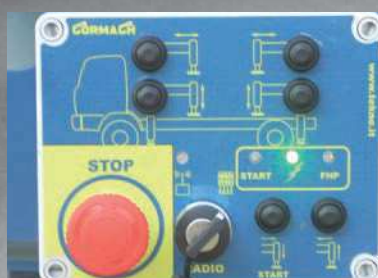
Comandi stabilizzatori elettrici Electric controls of the outriggers Commande stabilisateurs électriques Abstützungen elektronisch gesteuert (oder elektronisch überwacht?)
